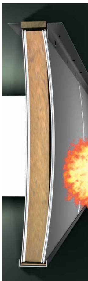
Det mesta av elementets böjhållfasthet förloras när limningen mellan den brandutsatta sidans plåt och kärnan går förlorad. Elementets egenvikt bärs då upp av infästningar till profiler.
